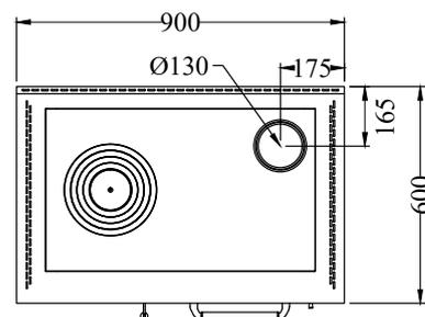
Versione con uscita fumi a destra. La versione con uscita fumi a sinistra è simmetrica.
